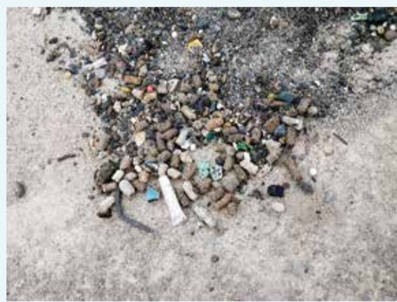
(写真①) 沈砂池で沈んだ砂と共に回収されたごみ
