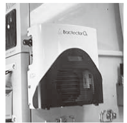
オゾンガス発生装置
