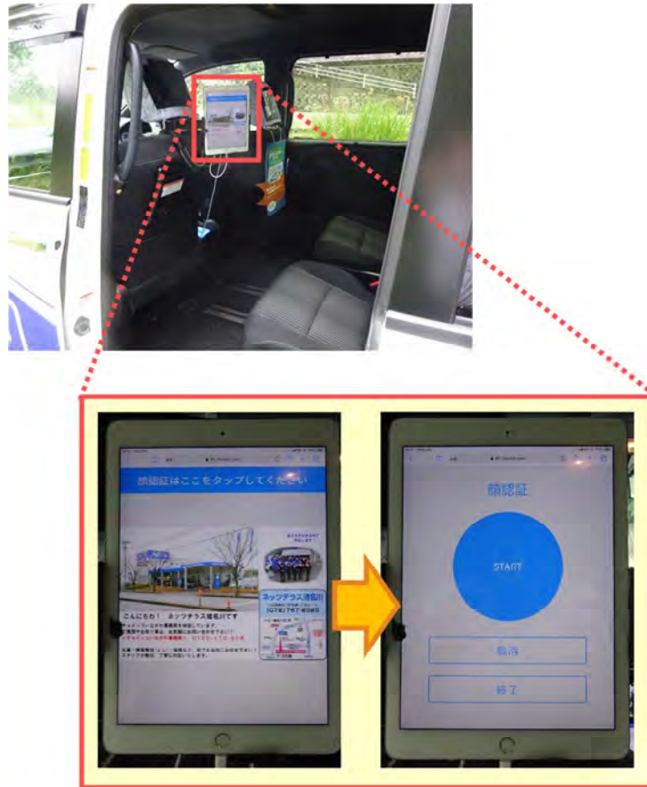
図 2.25 顔認証システムの車載状況
