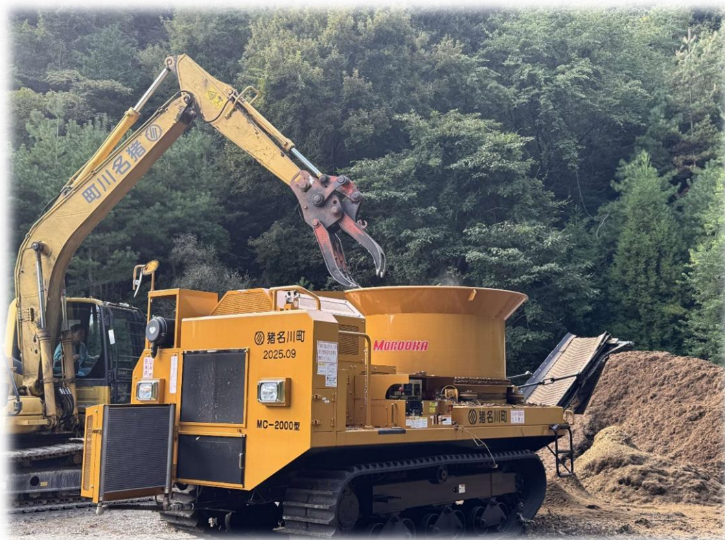
写真3：バーク堆肥製造の様子（破砕機に剪定枝を投入しているところ）
